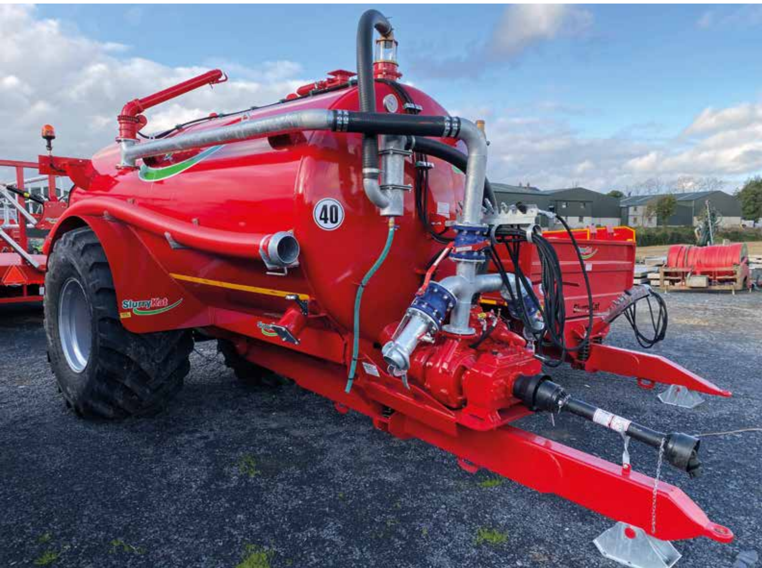
Overføringsbom: Kan fjernes raskt på mindre enn 5 minutter. Gaffellommer sørger for sikker håndtering.
