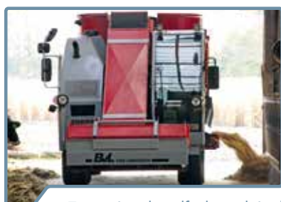
Tværgående udfodringsbånd foran med sideforskydning (option)
