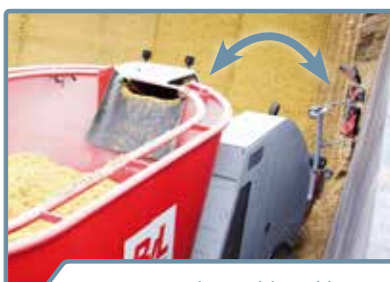
Sidespejl kan klappes ind elektrisk
