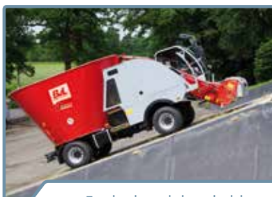
Firehjulstræk kan kobles til
