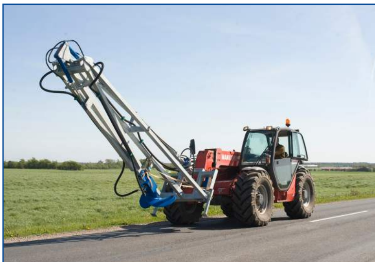
Transportstilling når omrører skal flyttes til næste tank
